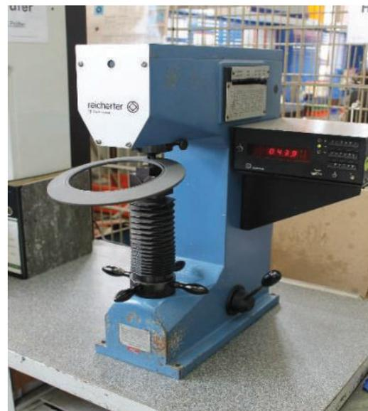
Bild 6.1: Härteprüfung HRC
