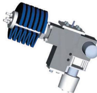
Bild 4.3: Schematische Darstellung eines Federspeicherantriebs
