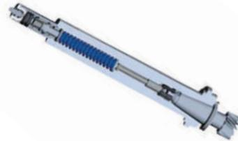
Bild 4.8: Schematische Darstellung eines Werkzeugspanners
