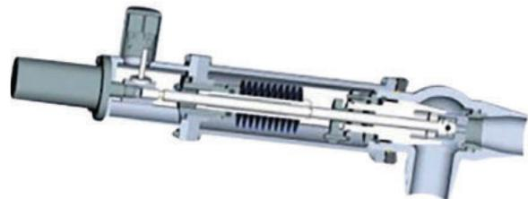
Bild 4.2: Schematische Darstellung eines Sicherheitsventils
