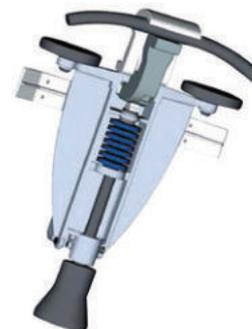
4.10: Schematische Darstellung einer Seilbahnklemme
