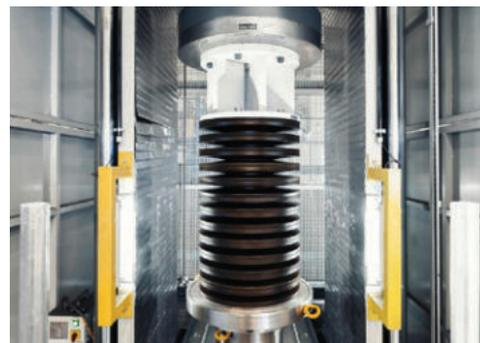
Bild 6.5: 1600 kN Federkraftprüfmaschine
