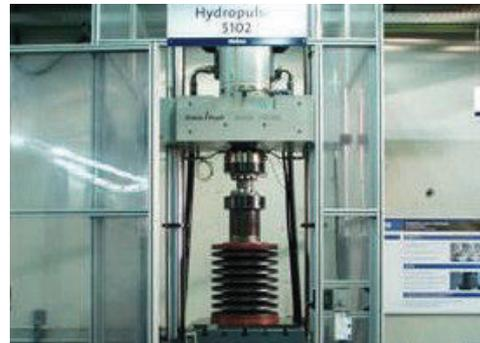
Bild 6.3: Schwingprüfung von Federsäulen
